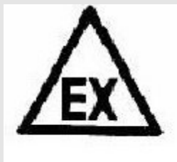
Locale con possibile presenza di atmosfera esplosiva
